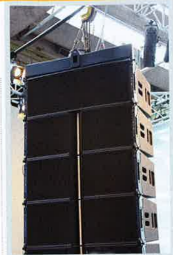
Le nouveau système ligne source d'Alcons, le LR24, avec le tweeter à ruban central version grand format.
